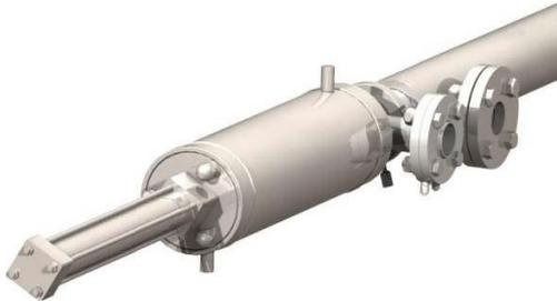
Unicus® est un échangeur de chaleur à surface raclée conçu pour les applications à fort taux d'encrassement ou avec des fluides visqueux. Sa conception est basée sur un échangeur de chaleur traditionnel calandre et tubes avec des éléments raclant à l'intérieur de chaque tube interne. Les racleurs se déplacent d'avant en arrière grâce à un vérin hydraulique. L'action des racleurs a deux avantages très importants :
