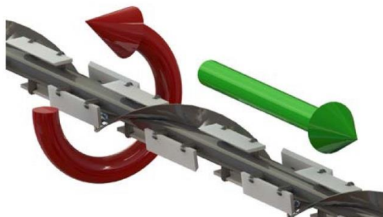
La rotation de l'axe central induit un effet pompe sur le produit
