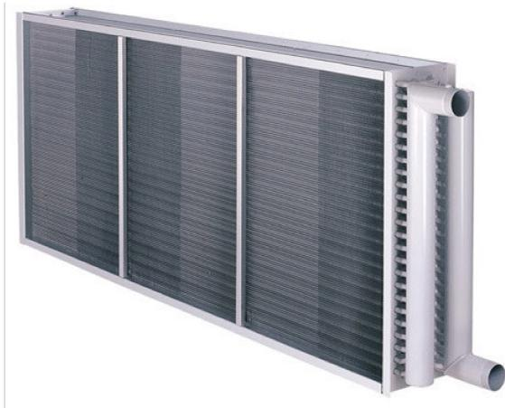
Les échangeurs de chaleur de type batterie à ailettes sont typiquement conçues pour un échange thermique air/eau. L'eau circule à travers un réseau de tubes dans le corps de la batterie, et les ailettes permettent d'optimiser la surface d'échange avec l'air traversant l'appareil.
