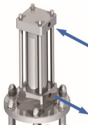
Entrée / Sortie du vérin actionnant le piston
